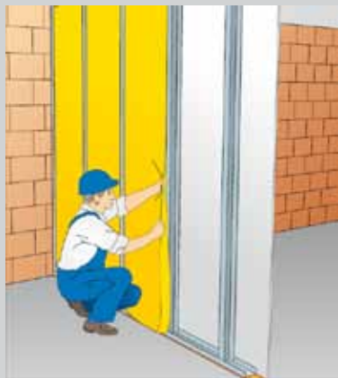
rys. 5 Montaż izolacji z płyt z wełny mineralnej szklanej ISOVER
