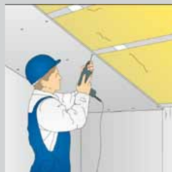
rys. 4 Pokrycie płytami gipsowo-kartonowymi
