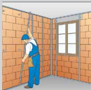
rys. 2 Mocowanie profili CD60 ULTRASTIL
