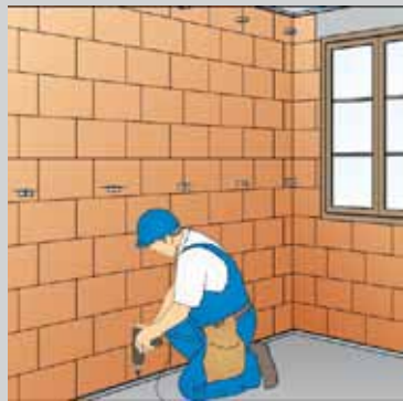
rys. 1 Mocowanie uchwyty typu ES
